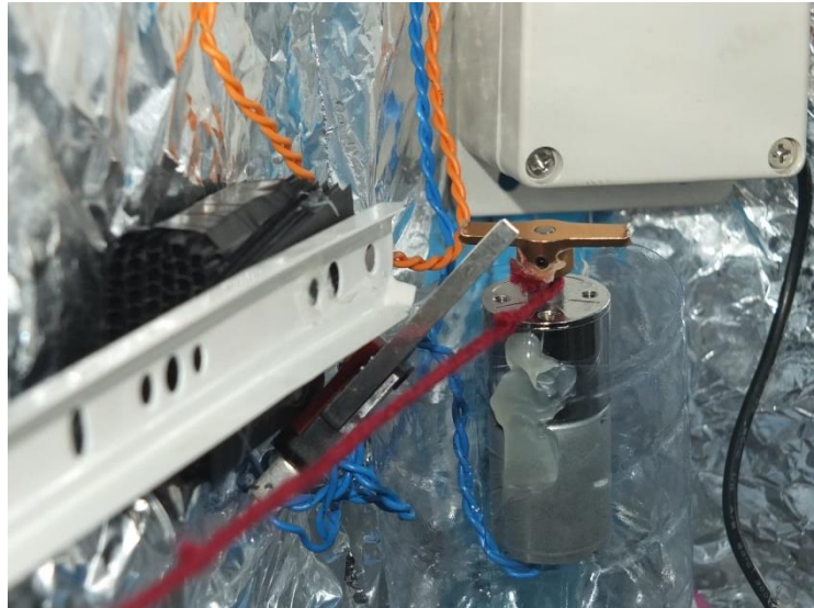
ภาพที่ 3 มอเตอร์หมุนถาดปลาและไมโครสวิตช์
