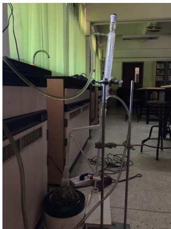
ภาพที่ 3.4 การทำงานของเครื่องกลั่นแบบสกัดโดยไอน้ำ
