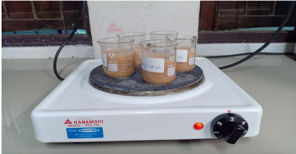
ภาพที่ 10 แป้งผสมน้ำกลั่นและกลีเซอรินในอัตราส่วนที่ต่างกันอุ่นในเตาไฟฟ้าเวลา 15 นาที
