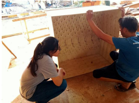
รูป ก. ตัดไม้อัด 4 แผ่น กว้าง 100x100 แล้วนำไม้อัดมาประกอบให้เป็นกล่องสี่เหลี่ยม
